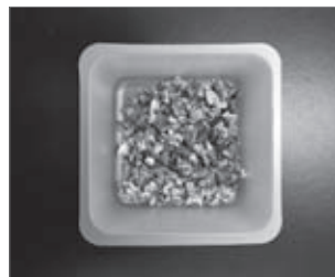
雨水タンク製作のための材料評価実験 純プラ / 廃プラ / 相容化剤を熔融ブレンドしたもの
