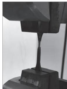
雨水タンク作製 (引張試験)
